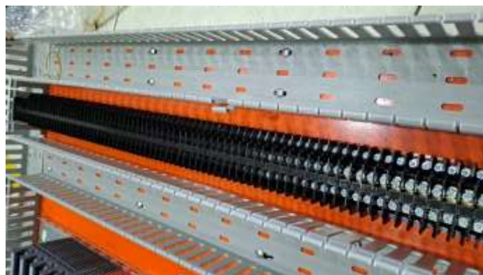
Gambar 2. 10 Pembuatan base plate panel Apply Bond SCARA
