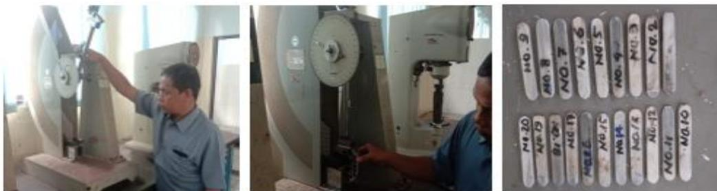
Gambar 6. Proses Pengujian Impak
