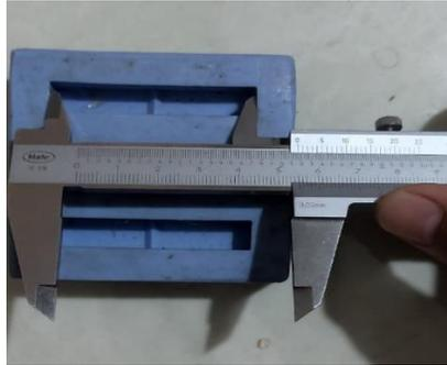
Gambar 3.7 Ukuran Panjang Spesimen Pada Cetakkan Sesuai Standar ASTM E23
