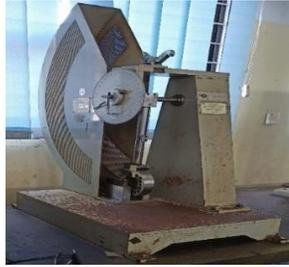
Gambar 3.2 Alat Uji Impak *Charpy*
