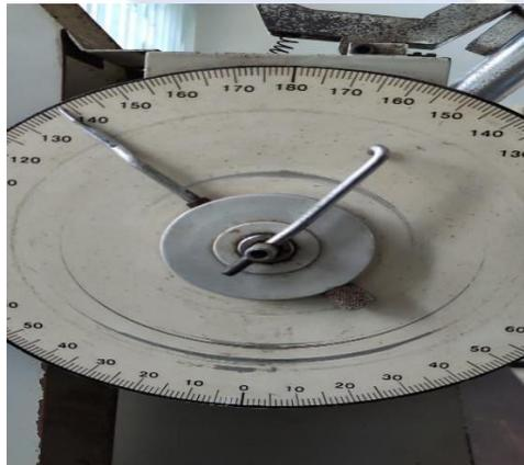
Gambar 4.6 Nilai Data Awal Pada Mesin Uji *Impact Charpy*
