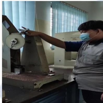
Gambar 4.5 Proses Pengujian Impact
