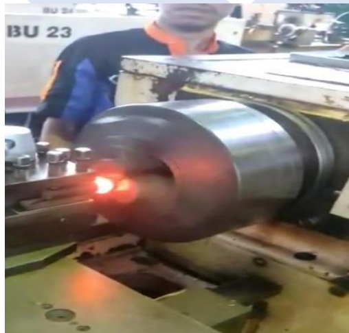
Gambar 3. 12 Proses penekanan yang terjadi pada pengelasan gesek
