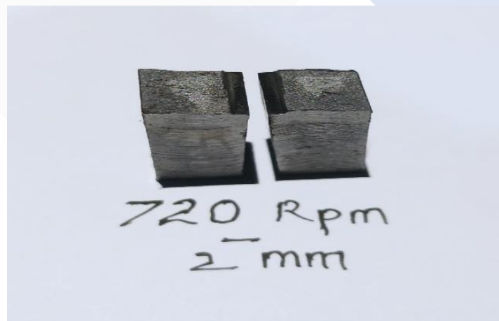
Gambar 4. 5 Hasil Patahan Spesimen Nilai Energi Impact
