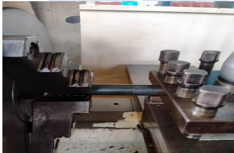
Gambar 3. 10 Permukaan ke dua benda kerja pada posisi center
