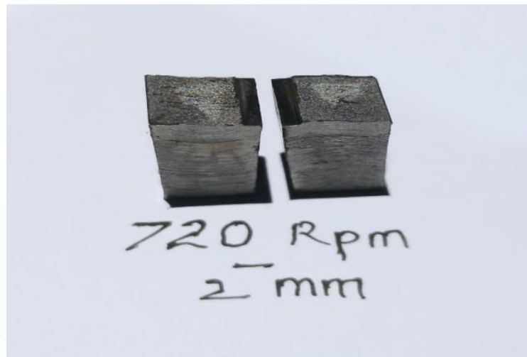
Gambar 4. 8 Hasil Patahan Spesimen Nilai Terendah Harga Impak
