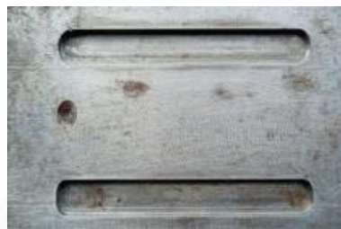
Gambar 3.12 Cetakan Spesimen Uji Impak
