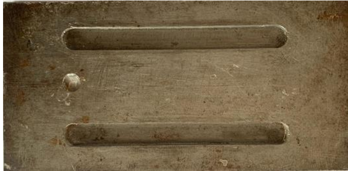
Gambar 3.11 Cetakan Spesimen Uji Bending
