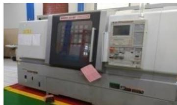
Gambar 3.2 Mesin Bubut *CNC MORI SEIKI NLX 2500 Y*
