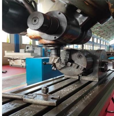
Gambar 4. 17 Pembuatan segi enam pada poros *Stainless Steel*
