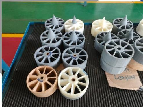
Gambar 4. 16 Hasil Proses *Inlet* dan *Outlet Turbo*
