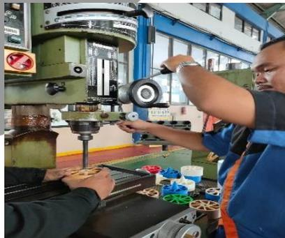
Gambar 4. 18 Pelobangan diameter komponen *Waterjet Thruster*
