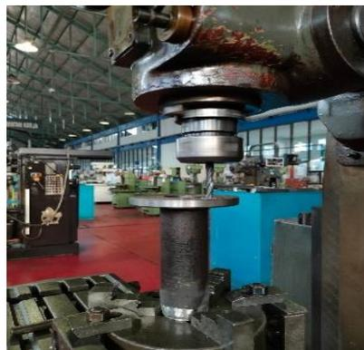
Gambar 4. 19 Pembuatan lobang *medium tail*
