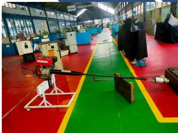
Gambar 4. 23 Bentuk mesin *Waterjet Thruster*
