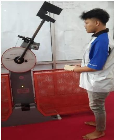
**Gambar 4.4** Proses Pengujian Impak
