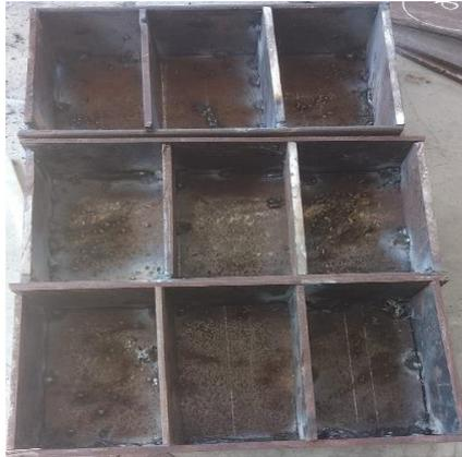
**Gambar 3.6** Kotak *Carburizing*
