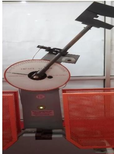
**Gambar 3.4** Alat Uji Impak
