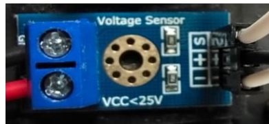
Gambar 4. 17 Pemasangan sensor tegangan DC
