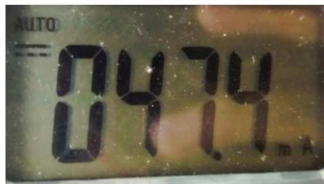
Gambar 4. 15 Tampilan arus pada multimeter saat pengujian sensor INA219
