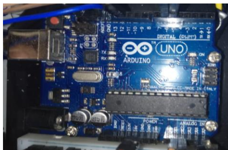
Gambar 4. 23 Pemasangan Arduino UNO
