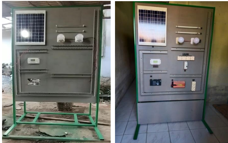
Gambar 4. 4 Proses Pembuatan Trainer kit Sistem PLTS
