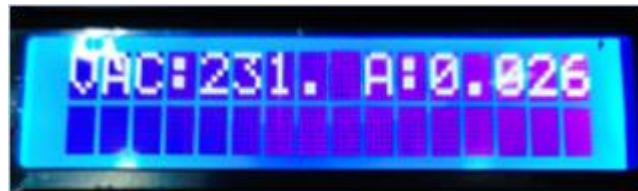
Gambar 4. 9 Tampilan di LCD Pengujian sensor PZEM-004T
