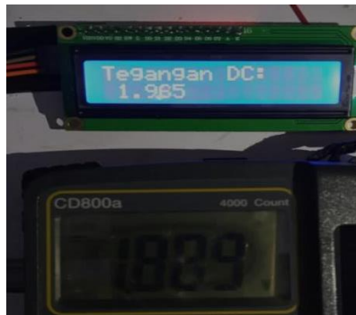
Gambar 4. 19 Pengujian A sensor tegangan DC terhadap alat ukur multimeter
