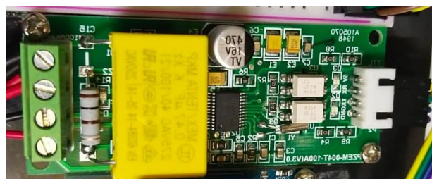
Gambar 4. 7 Pemasangan sensor PZEM-004T
