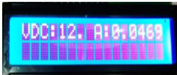
Gambar 4. 14 Tampilan di LCD Pengujian sensor INA219
