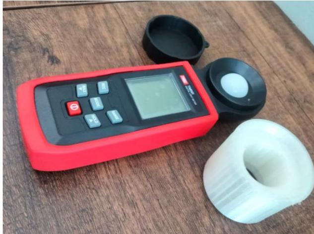
Gambar 3.5 Digital Lux Meter(sumber:dokumentasi pribadi)
