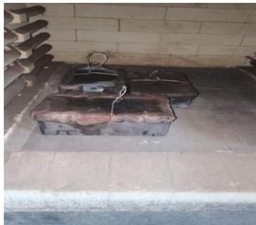
Gambar 3.17 Proses Pemasukan Kotak *Carburizing* Ke Dalam Oven.
