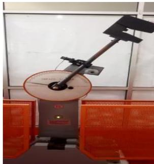
Gambar 3.21 Proses Pengujian Impak.
