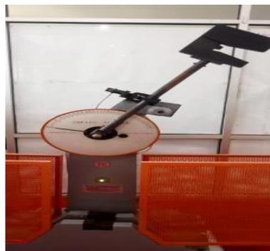
Gambar 3.8 Alat Uji Impak.
