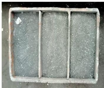
Gambar 3.15 Proses Pemasukan Benda Kerja Kedalam Kotak *Carburizing*.
