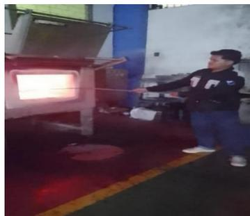
Gambar 3.18 Proses Pengeluaran Kotak *Carburizing* Dari Dalam Oven.
