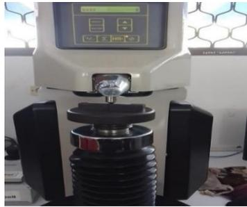
Gambar 4.1 Alat uji kekerasan *hardness tester*.
