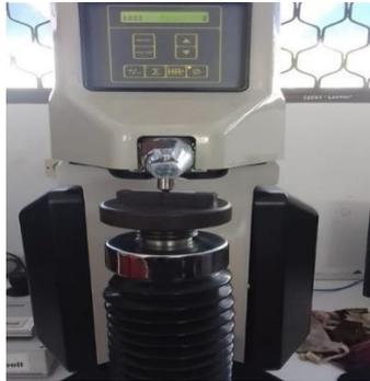
Gambar 3.20 Proses Pengujian Kekerasan *Rockwell*.
