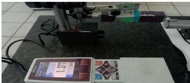
Gambar 3. 23 Proses pengukuran kekasaran permukaan benda kerja
