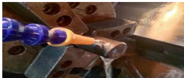
Gambar 3. 15 Proses Pemasangan Benda Kerja
