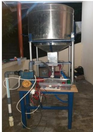
*Gambar 4. 13 Konstruksi assembly automatic feeder*
