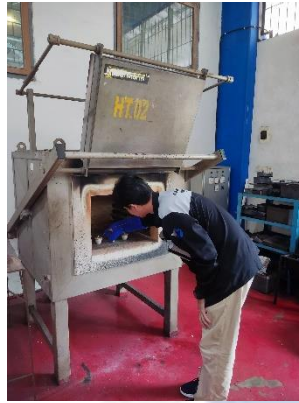
Memasukkan Cawan Sampel ke dalam mesin Furnace 02
