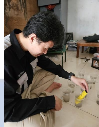
Pengujian sampel menggunakan pH meter
