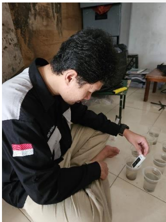
Pengujian sampel menggunakan TDS meter
