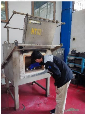
Mengambil Cawan Sampel setelah di aktivasi
