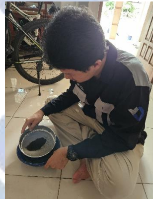
Mengayak sampel dengan mesh 200
