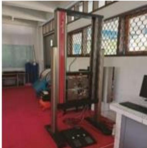
Gambar 3. 4 Mesin Zwick Roell Z020
