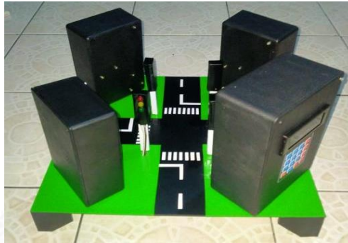
Gambar 4.3 Pemasangan lampu lalu lintas dan box panel
