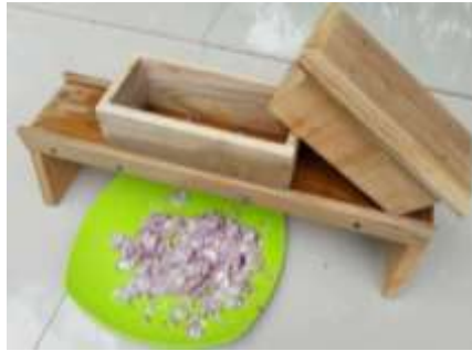
Gambar 1.1 alat pengiris bawang manual
