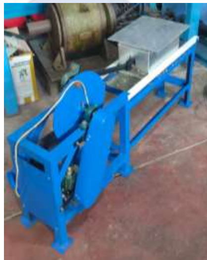
Gambar 4.7. mesin pengiris bawang
