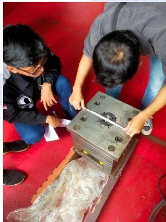
Gambar 4. 1. Proses Pengukuran Pada Cetakan Tutup Galon
