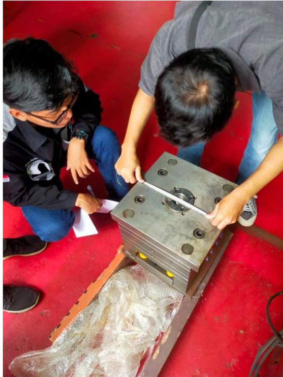
Gambar pengukuran dimensi cetakan
