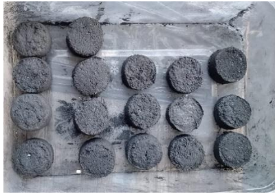
Gambar 4.1 Briket Hasil Uji Penekanan
