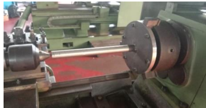
Gambar 4.9 Proses Pembuatan Poros.
