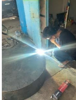
Gambar 4.8 Proses Pembuatan Wadah Granulator.
