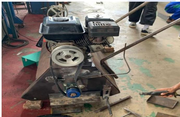
Gambar 4.26. Perbaikan Pengencang *Belt*
