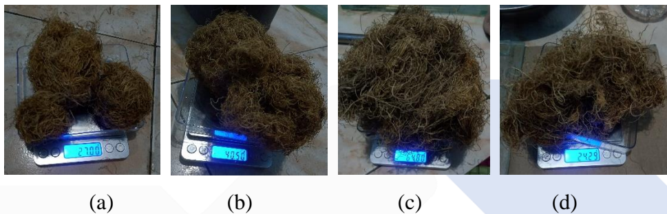
Gambar 4. 6 Hasil Penimbangan Berat Serat TKKS (a) komposit 1, (b) komposit 2, (c) komposit 3, (d) komposit 4
