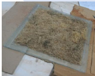
Gambar 4. 7 Susunan Serat Pada Cetakan
