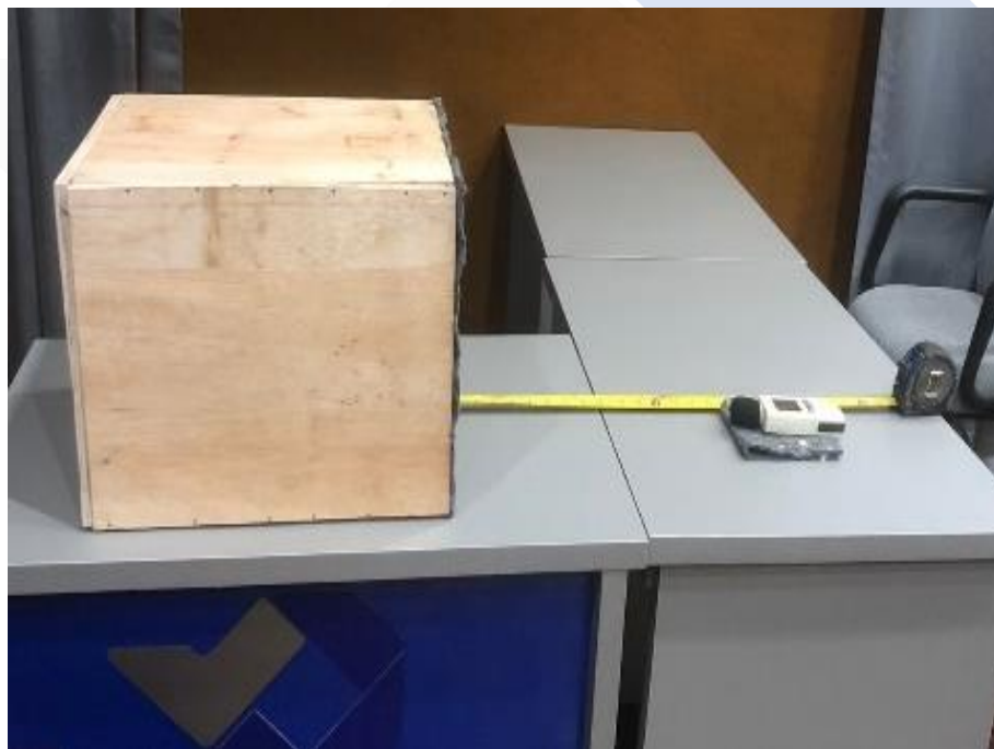
Gambar 4. 10 Proses Pengujian Absorpsi Suara
