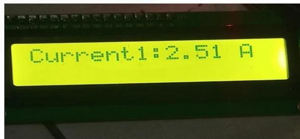
Gambar 4. 7 Sampel Pengujian Sensor Arus
