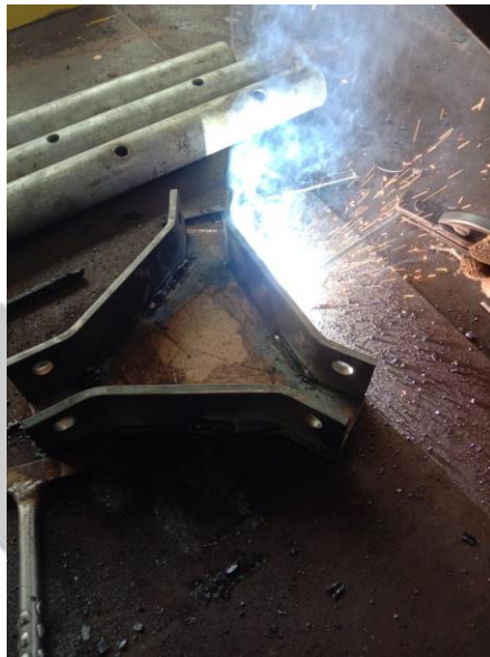
Gambar 3. 14 Pengelasan kepala tripod
