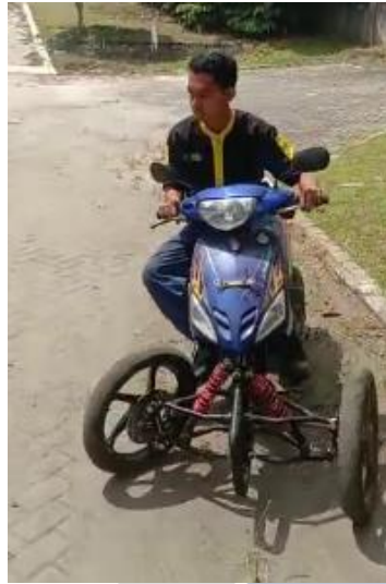
Gambar 4. 33 Uji Belok Beban 60kg
