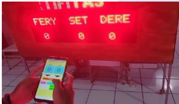
Gambar 4.6 hasil uji tampilan pada papan skor
