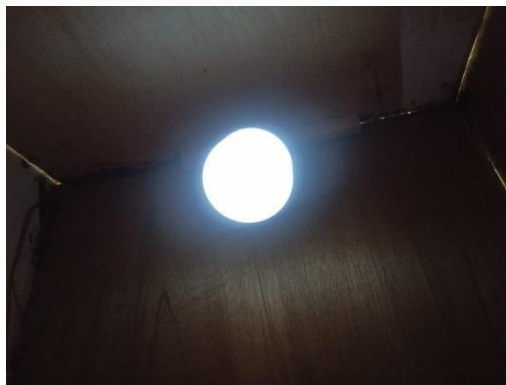
Gambar 4. 9 Pengujian dari Hasil MOSFET dan Lampu Menyala Redup ( 4V )
