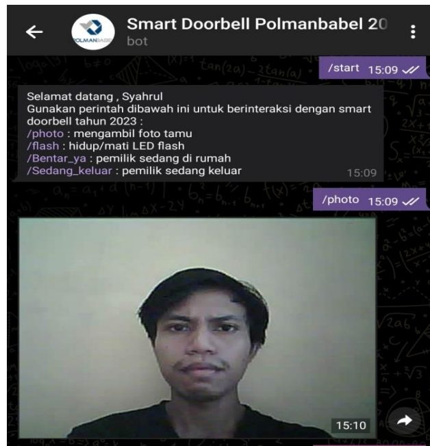
Gambar 4.3 Hasil Pengujian Kamera ESP32-CAM
