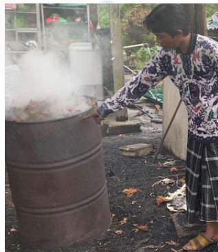
Gambar 2.2 Proses pembakaran tempurung kelapa
