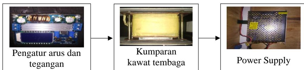
Gambar 4.1 Diagram blok magnet induksi
