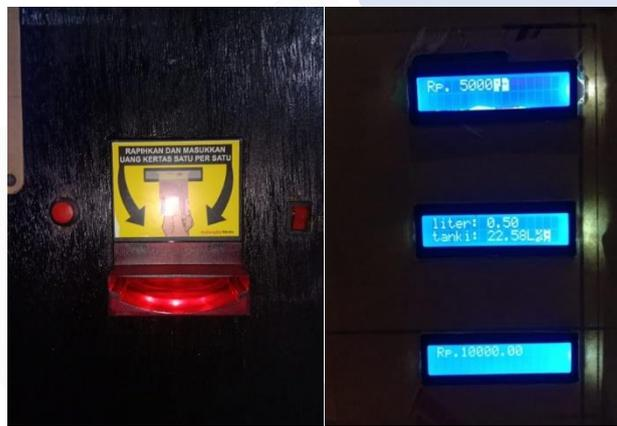
Gambar 4. 9 Hasil Pengujian Menggunakan Modul ITL BV 20 Berbasis Arduino Mega.
