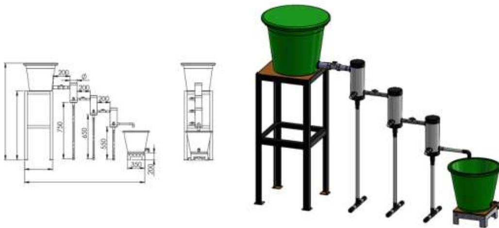
Gambar 3. 2 Desain Kontruksi Sistem Pemjernihan Air
