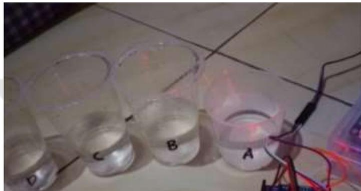
Gambar 4. 5 Sampel Pengujian Kalibrasi Sensor TDS
