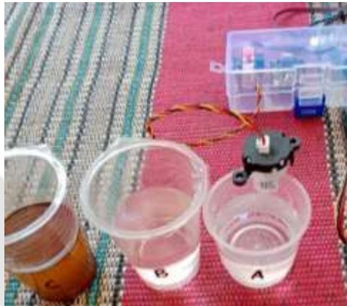
Gambar 4. 9 Sampel Pengujian Sensor *Turbidity*
