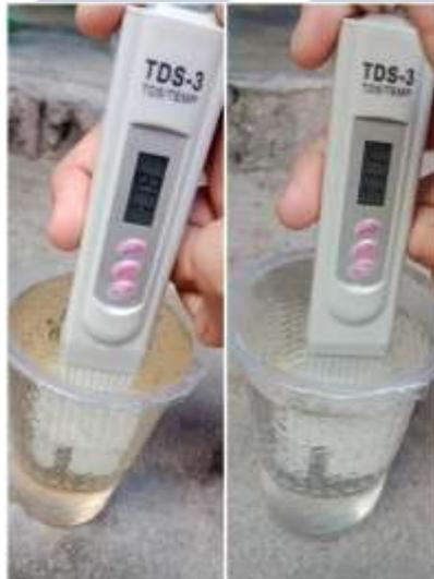
Gambar 4. 16 Perbandinngan PPM Sebelum dan Sesudah Difilter
