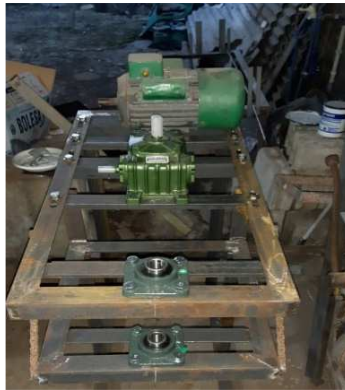
Gambar 4. 15 Pemasangan Gear Box dan Motor Listrik
