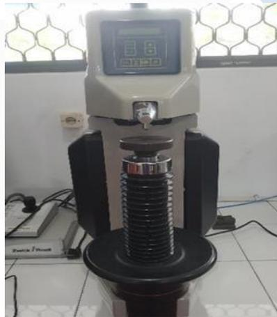
Gambar 2.3 Alat uji kekerasan tipe *Rockwell Cone*
