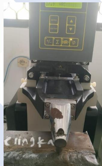
Proses Pengujian Kekerasan
