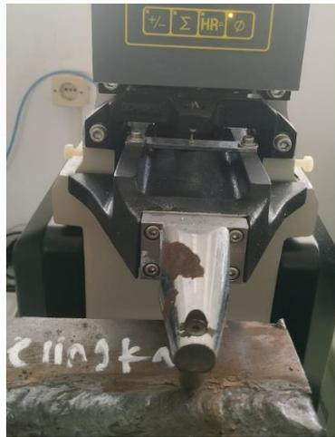
Gambar 4.5 proses pengujian kekerasan rockwell.
