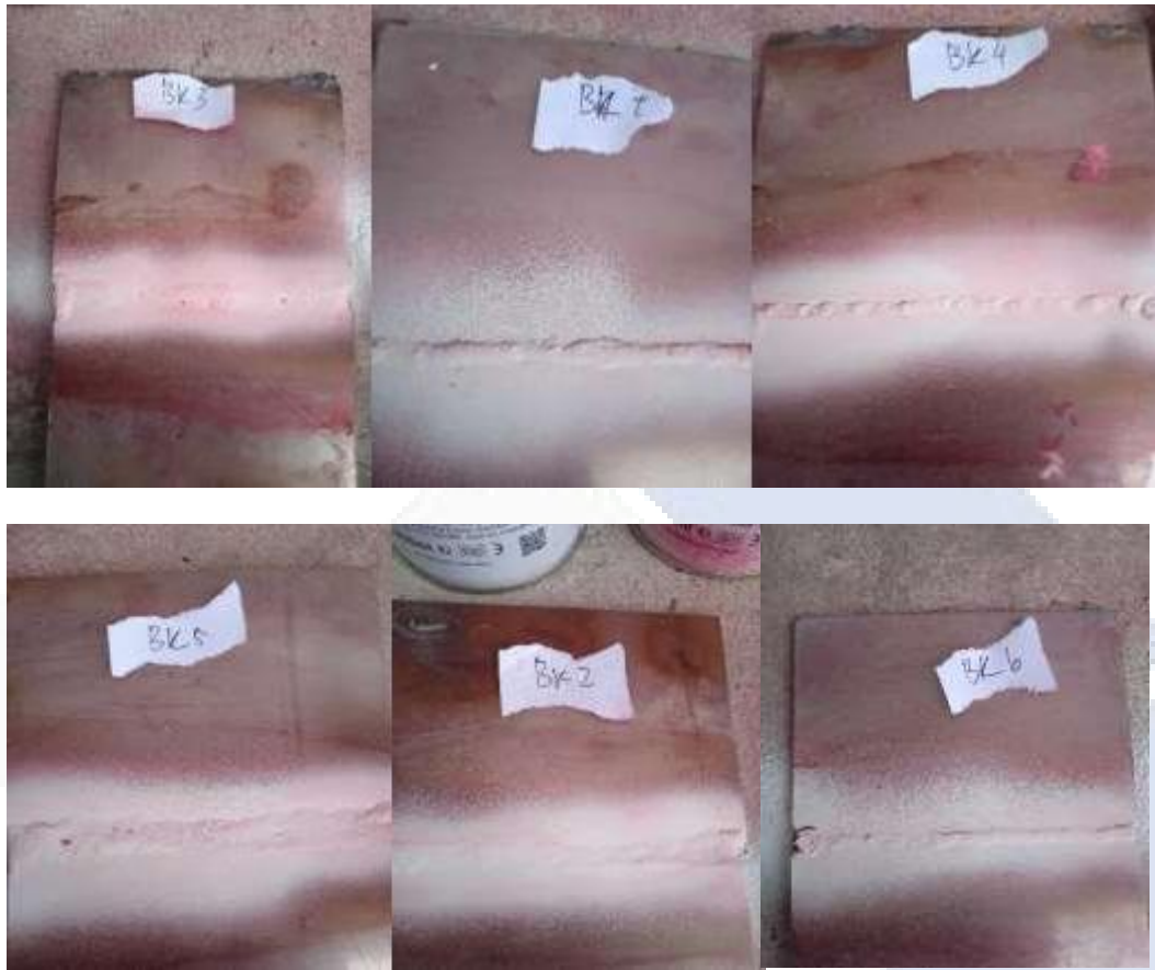
Gambar 4.4 Hasil Spesimen 2 Yang Telah Diuji dengan Dye Penetrant
