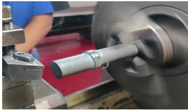
Gambar 4. 5 Proses Bubut Setelah Di Las Gesek
