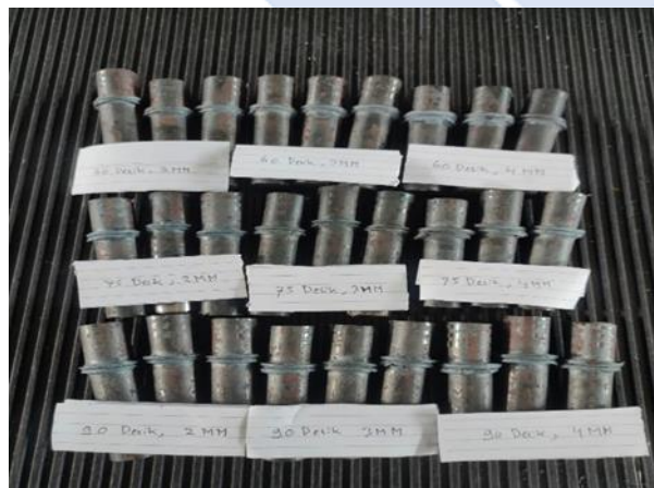
Gambar 4. 4 Hasil Setelah Proses Las Gesek
