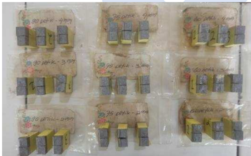
Gambar 4. 8 Patahan Spesimen Setelah Uji Impak
