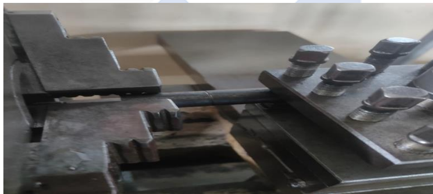
Gambar 4. 2 Benda Kerja Dalam Posisi Center line .
