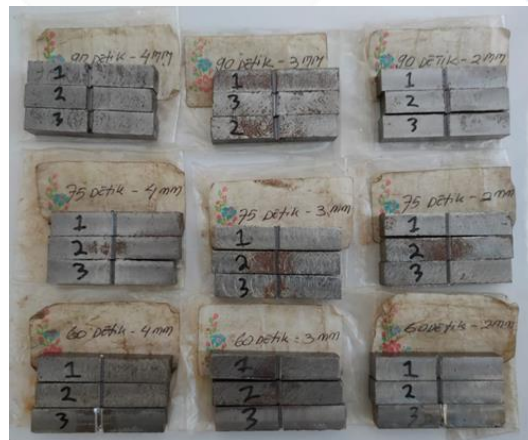
Gambar 4. 7 Setelah Proses Milling Dan Pembuatan Takik
