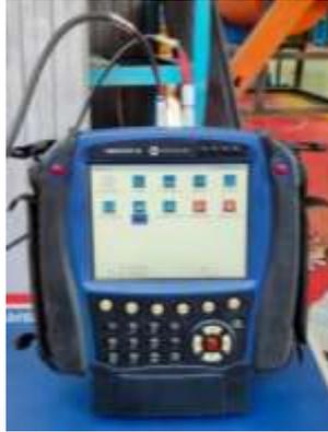
Gambar 3. 6 Alat Uji Vibroport 80
