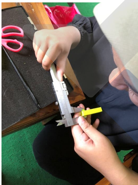
Proses Pengukuran Spesimen Uji yang Sudah Dicitak
