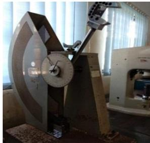
Gambar 3. 14 Alat Uji Impak
