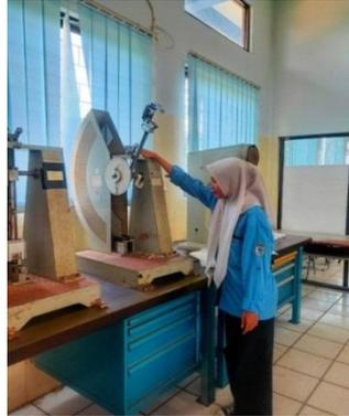
Gambar 4.11 Proses Pengujian Impact
