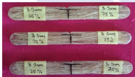
Gambar 4.10 Spesimen Uji Impak
