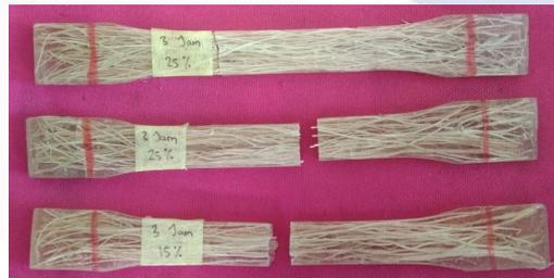
Gambar 4.3 Spesimen Setelah Dilakukan Uji Tarik
