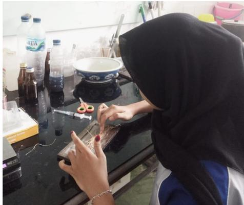
6. Menuangkan campuran resin dan katalis pada cetakan, tunggu spesimen hingga kering atau dijemur dibawah sinar matahari.
