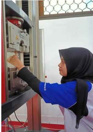
Gambar 4.2 Proses Pengujian Tarik
