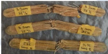
Gambar 4.12 Spesimen Setelah Dilakukan Uji Impact
