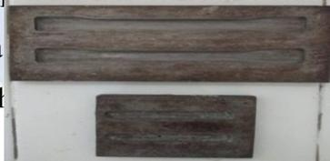
Gambar 3.3 Cetakan Uji Tarik Dan Uji Impak
