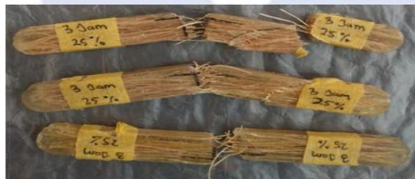
Gambar 4.16 Hasil Deformasi Sampel Nilai Uji Impact Tertinggi
