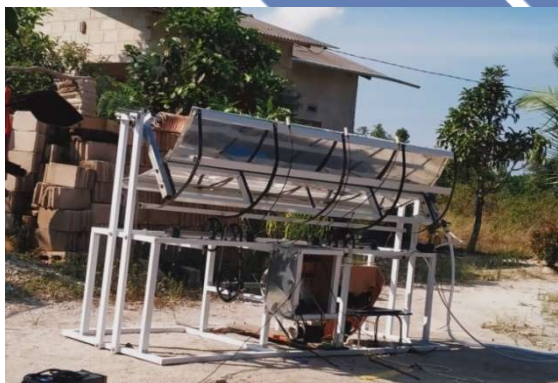
Gambar 3.5 Konstruksi Single Axis Solar Water Heater Parabolic Menggunakan Kolektor Model Spiral
