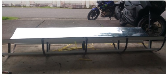
Gambar 3.9 Bentuk konstruksi reflektor parabolik
