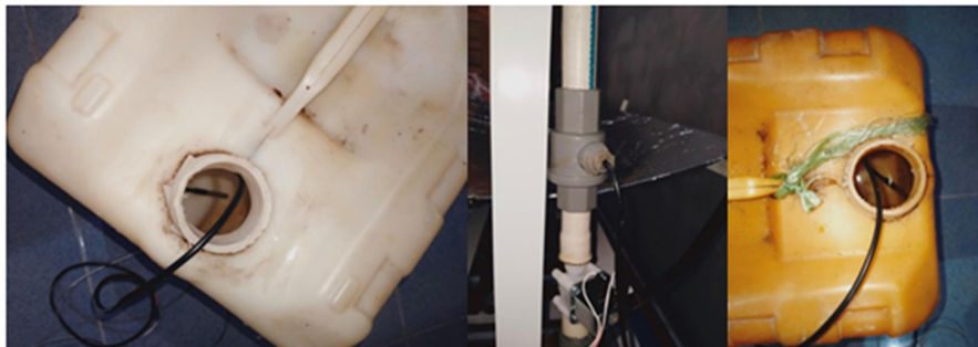
Gambar 3.16 Pemasangan Sensor Suhu DS18B20
