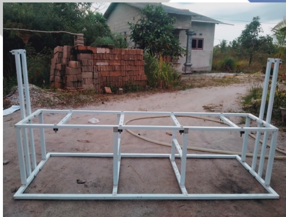
Gambar 3.6 Kerangka Single Axis Solar Water Heater Parabolic Menggunakan Kolektor Berbentuk Spiral
