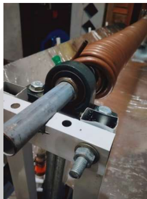
Gambar 3.12 Pemasangan Bearing pada Reflektor Parabolik
