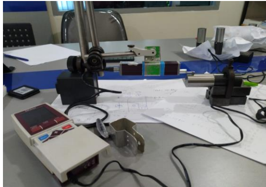
Gambar 3. 23 Proses pengukuran kekasaran permukaan benda kerja
