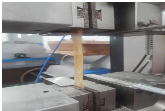
Gambar 4.3 Proses Pengujian Tarik
