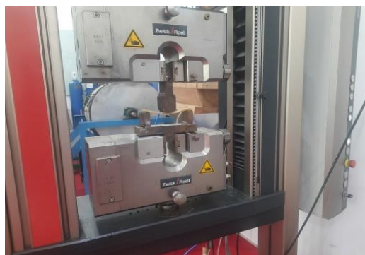
Gambar 4.6 Proses Pengujian Lentur
