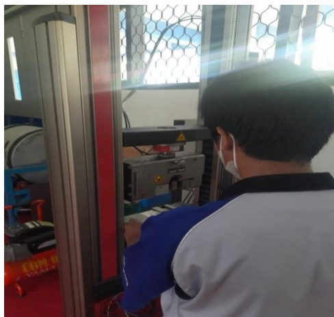
Proses memasang spesimen di mesin
