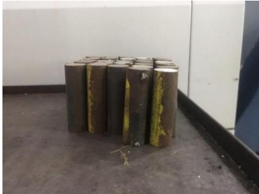
Gambar 3. 2 Benda kerja baja AISI 1045
