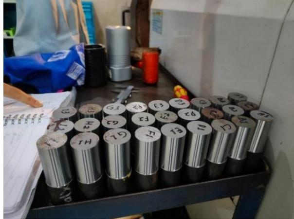
Gambar 3. 10 Benda kerja hasil pembubutan
