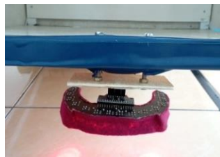
Gambar 4.3 Pemasangan Sensor Garis
