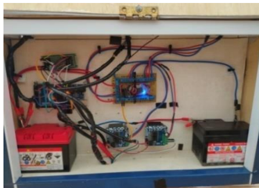
Gambar 4.8 Pemasangan dan Perakitan Rangkaian Elektrik Komponen
