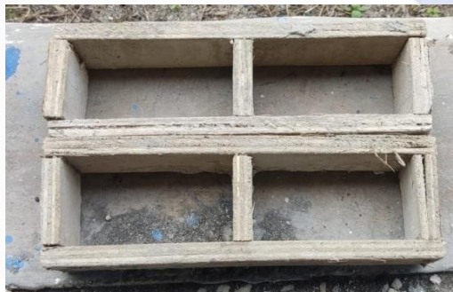
Gambar 3.2 Cetakan Bata Ringan
