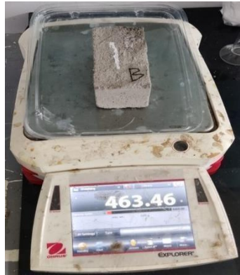
Gambar 4.2 Penimbangan sampel bata ringan
