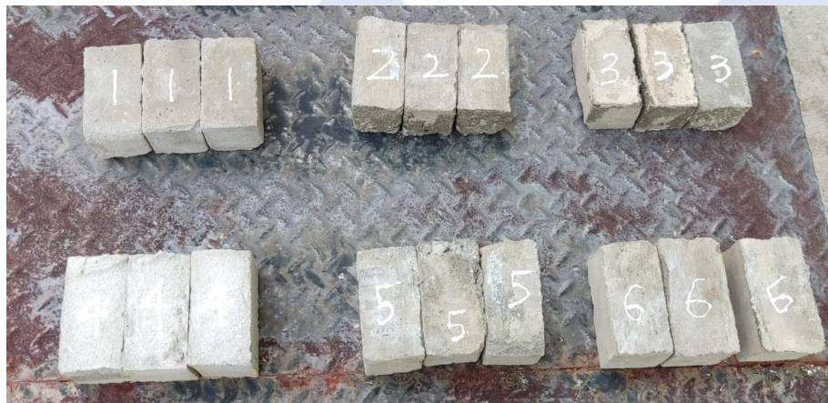
Gambar 4.1 Sampel bata ringan
