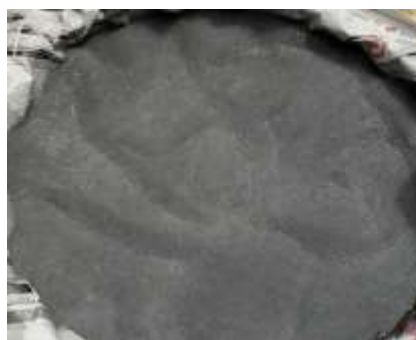
Gambar 3. 2 Serbuk aluminium hasil daur ulang
