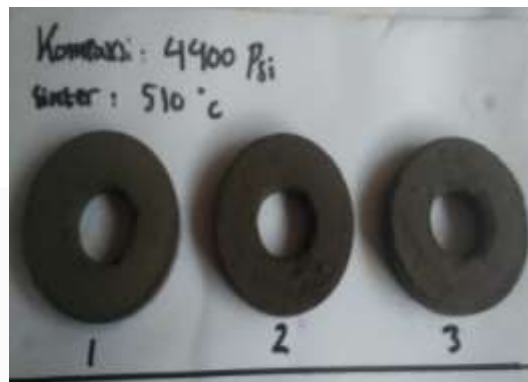
Gambar 4. 13 Sampel Setelah Pengujian Densitas
