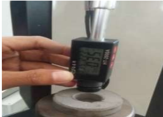
Gambar 4. 8 Proses Pengujian Kekerasan
