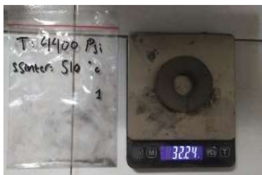
Gambar 4. 11 Proses Menimbang Spesimen Kondisi Kering
