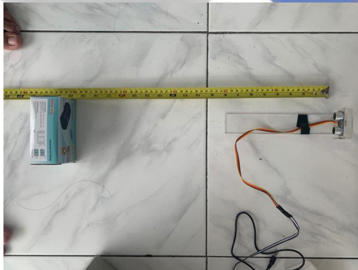
Gambar 4. 27 Pengujian Pembacaan Jarak dengan Sensor Ultrasonik dan Meteran
