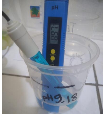
Gambar 4. 15 Pengujian Sensor pH dan pH Meter
