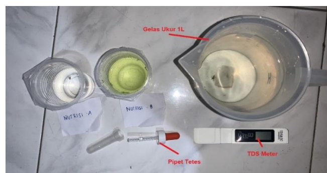
Gambar 4. 39 Pengujian Hubungan Penambahan Nutrisi AB Mix Terhadap Nilai PPM
