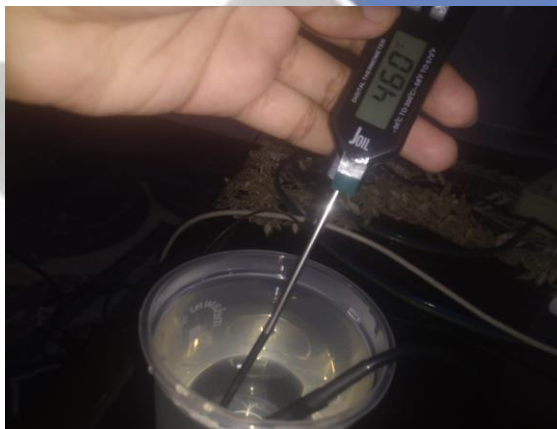
Gambar 4. 20 Proses Pengujian Suhu dengan Sensor Suhu DS18B20 dan Termometer
