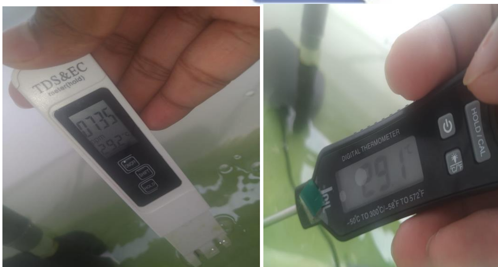
Gambar 4. 47 Pengujian nilai PPM dan Suhu Air
