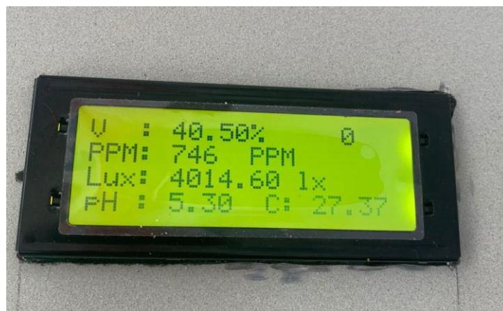
Gambar 4. 43 Hasil pembacaan semua sensor pada saat sistem berjalan pada LCD
