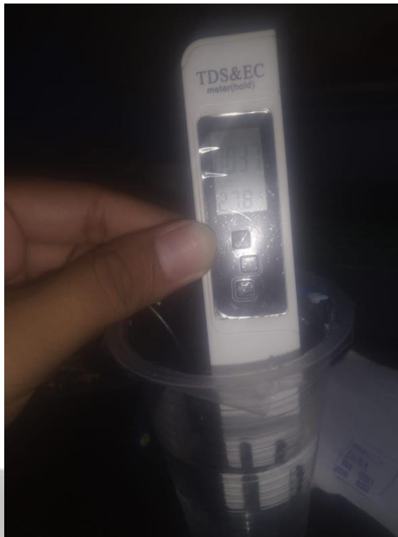
Gambar 4. 6 Pengujian Kadar PPM Menggunakan Sensor TDS dan TDS Meter
