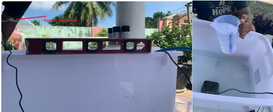
Gambar 4. 30 Kalibrasi Sensor Ultrasonik terhadap Pembacaan Volume Air
