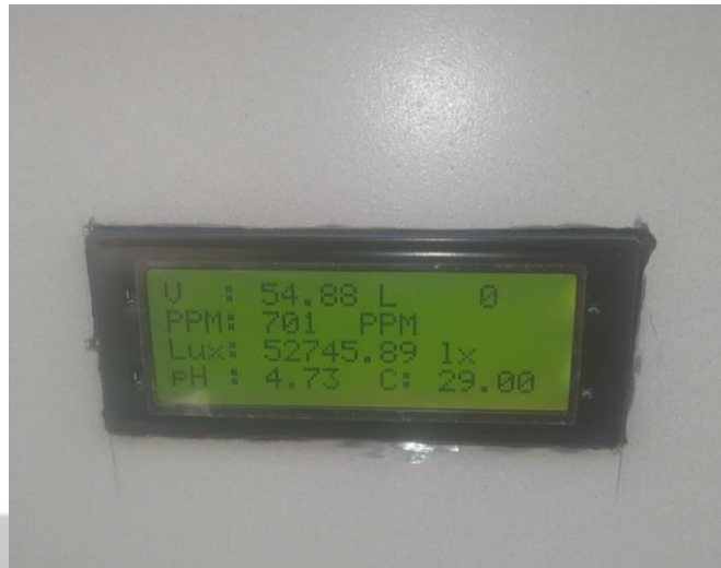
Gambar 4. 46 Tampilan LCD Pengujian Sensor pada Keseluruhan Sistem
