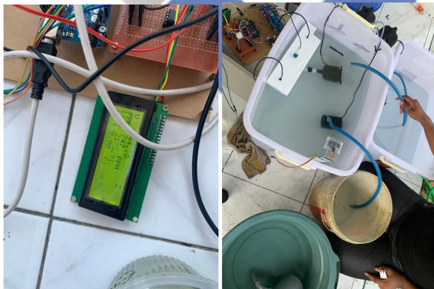
Gambar 4. 42 Pengujian Sistem Pengisian Air dan Nutrisi Otomatis
