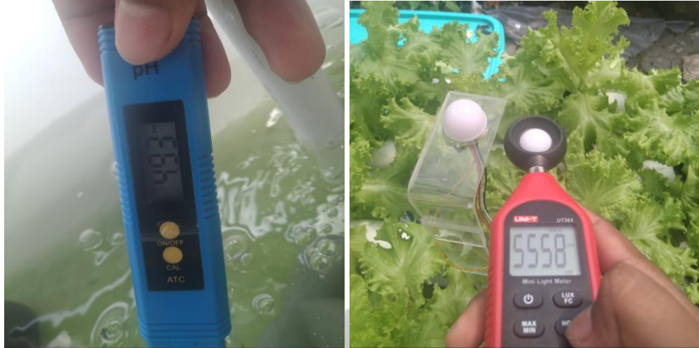
Gambar 4. 48 Pengujian nilai pH Air dan Intensitas Cahaya
