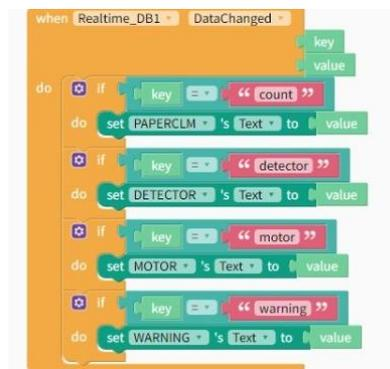
Gambar 4. 27 Logic Block Keseluruhan *Data Path*
