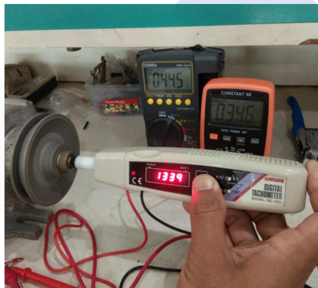
Gambar 4. 15 Pengujian Generator DC dengan Beban Resistor 10k
