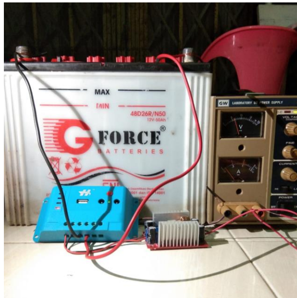
Gambar 4. 12 Pengujian SCC dengan Tegangan Input 6 Volt
