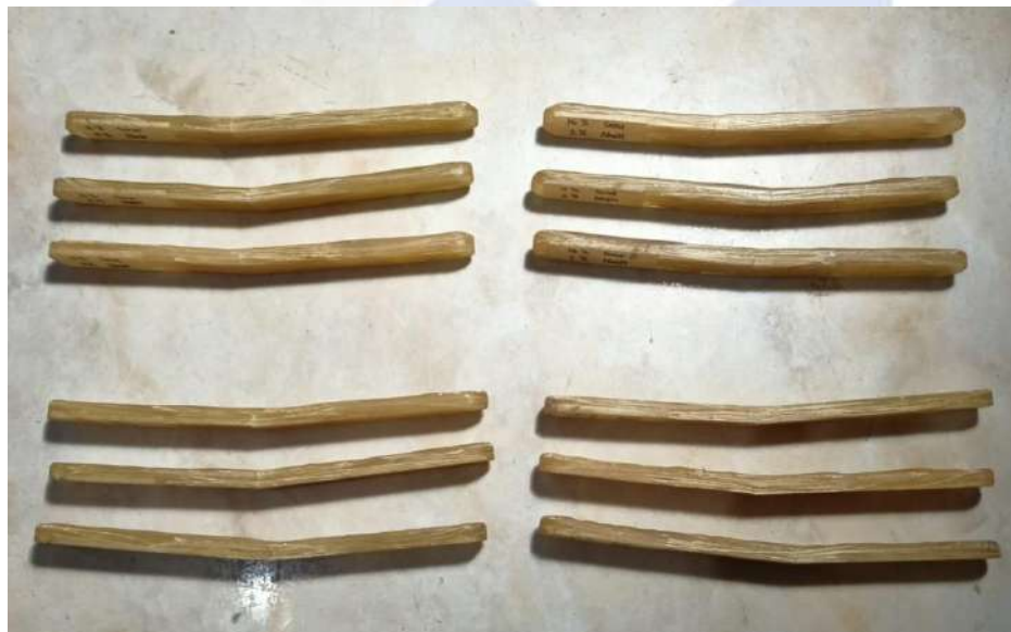
Bentuk spesimen setelah dilakukan uji bending .
