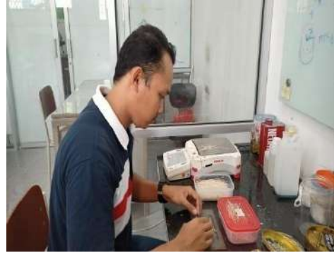
Menyusun serat ke dalam cetakan.
