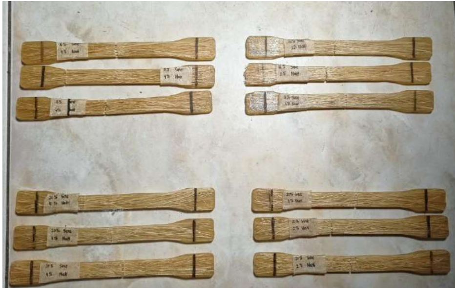
Bentuk spesimen setelah dilakukan uji tarik.
