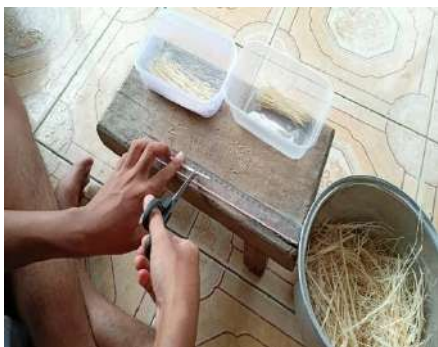
Pemotongan serat tebu sesuai ukuran.
