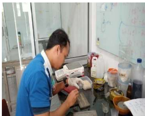
Menuangkan campuran resin dan katalis ke dalam cetakan yang telah disusun serat.
